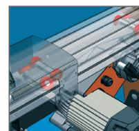
Das Spray System sorgt dafür, dass die Kühlung dort ankommt wo sie benötigt wird. Die Leistungsfähigkeit und Lebensdauer der Diamant-Trennscheibe wird dadurch erhöht.
