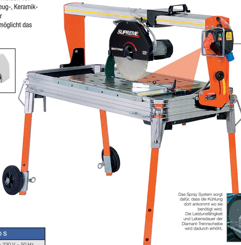
Laserführung für maximale Schnittgenauigkeit
