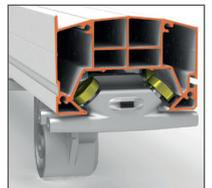
Die Fixierung verhindert das Verrutschen des Materials. Die Werkstücke werden passgenau!
