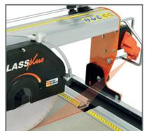
Das Spray System sorgt dafür, dass die Kühlung auch dort ankommt wo sie benötigt wird. Die Leistungsfähigkeit und Lebensdauer der Diamant-Trennscheibe wird dadurch erhöht.
